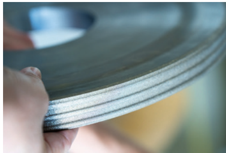
Effizientes Abrichten komplexer Profile
