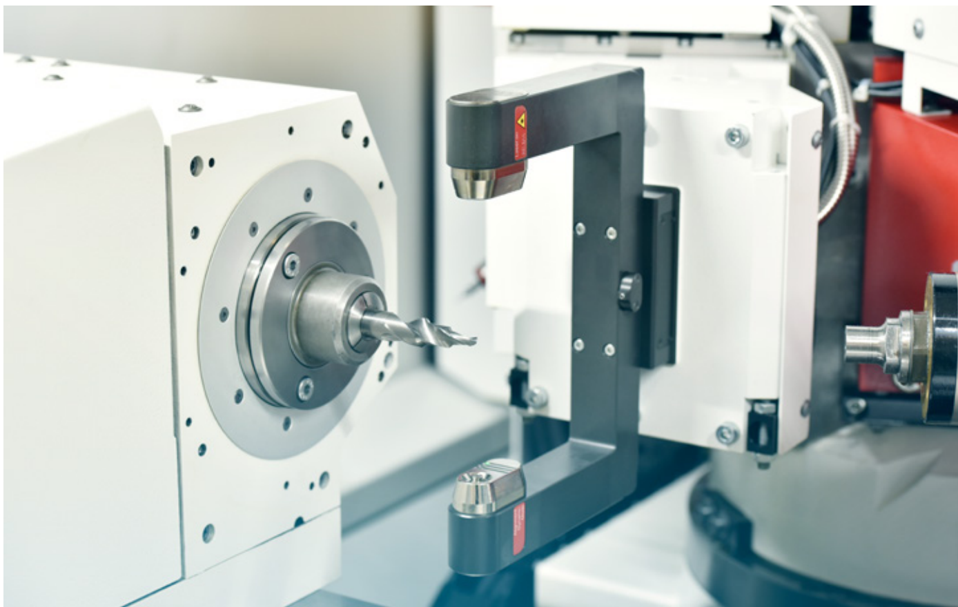
2 Misurazione laser senza contatto di utensili di precisione
