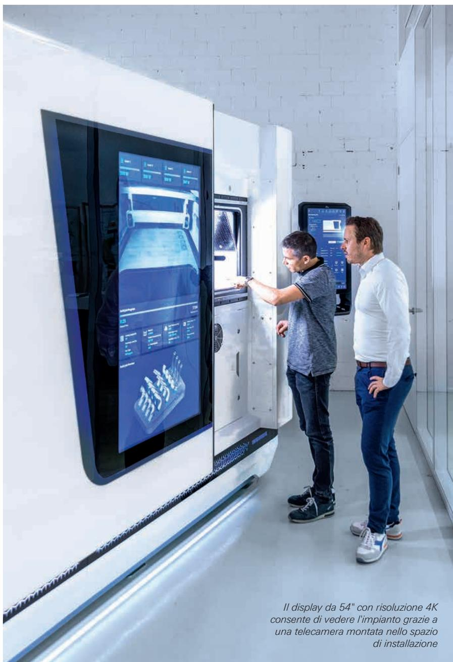
*Il display da 54" con risoluzione 4K consente di vedere l'impianto grazie a una telecamera montata nello spazio di installazione*
