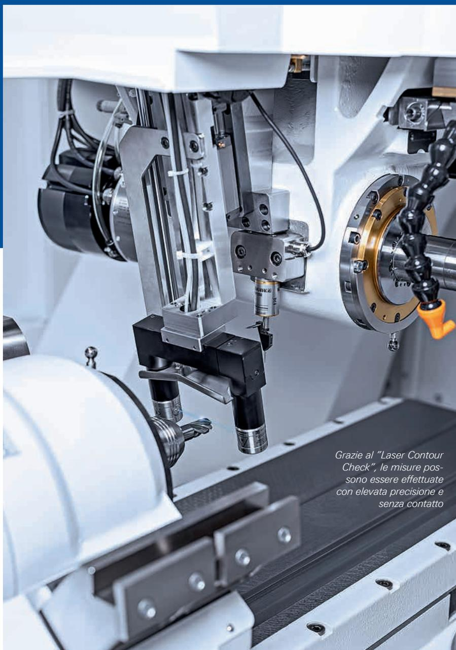
*Grazie al "Laser Contour Check", le misure possono essere effettuate con elevata precisione e senza contatto*
