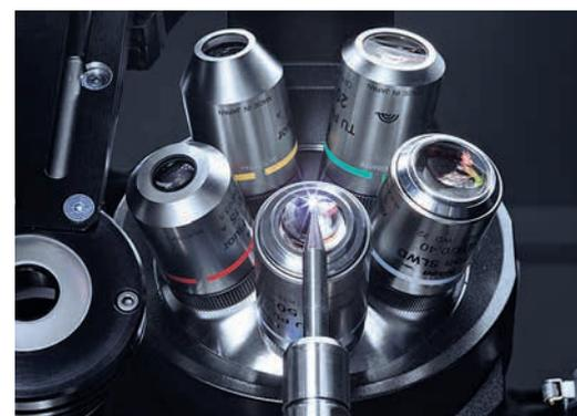
L'ottica microscopica della HELICHECK NANO consente di effettuare misure su scala nanometrica
