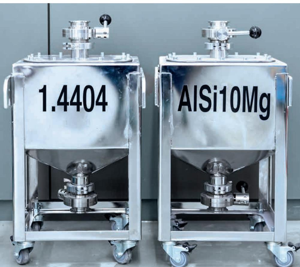
*In contenitori speciali da 37 litri dotati di rulli, le diverse polveri metalliche vengono stoccate nell'officina dell'IRPD. Le diciture qui riportate indicano le leghe: acciaio inox (sx) e alluminio-silicio (dx)*
